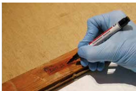
Les trois étapes nécessaires au marquage : dépôt du vernis, inscription puis nouveau vernis.
